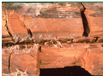
Ægte Hussvamp - sprækkeklodser. (Foto: PROTOX/Gori A/S)
