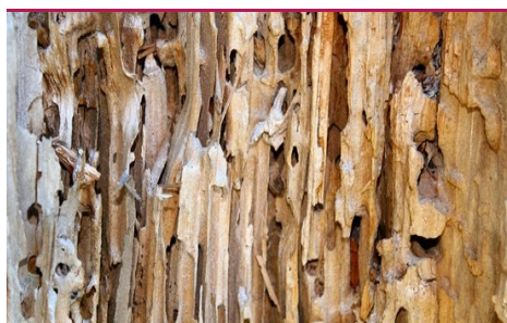
Herkules myrer - nedbrydning (gallerier) af træ. (Foto: ukendt)
