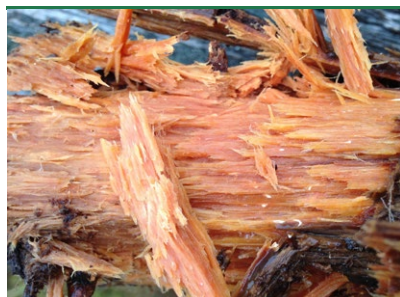
Mastesvamp - Nedbrudt træ. (Foto: PROTOX)
