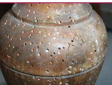
i 10 Alm Borebille - flyvehuller i bordben. (Foto: PROTOX)
