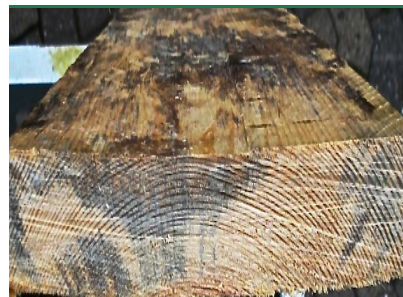
Blåsplint - bemærk dybtgående misfarvning på tværs af årringe. (Foto: PROTOX)
