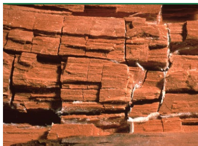
Brunmuld - svampen nedbryder cellulosefibrene og efterlader ligninen.
