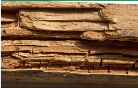
Rækkeporesvamp (Hvid Tømmersvamp) - nedbrydning. (Foto: PROTOX)
