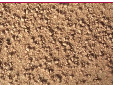
i 3 Husbuk - boremel med karakteristiske vinprop-formede ekskrementer. (Foto: PROTOX/EFI Global arkiv)
