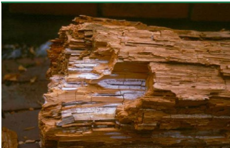
Hvid Tømmersvamp - nedbrydning og hvidt overflademycelium på brudflader. (Foto: EFI Global)
