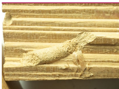
Træhveps - larvegang med hårdt pakket boremel. (Foto: PROTOX/EFI Global arkiv)
