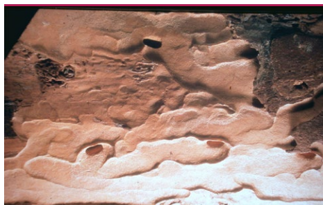
Violbuk - gnavspor i nåltræ mellem bark og træets yderste årringe. (Foto: Hussvamp Laboratoriet)
