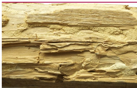
in 13 Husbuk - frilagte larvegange. (Foto: PROTOX/EFI Global arkiv)
