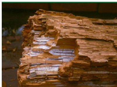
Hvid Tømmer-svamp - sprækkeklodser. (Foto: EFI Global)
