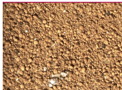
Egens Borebille - linseformede ekskrementer i boremel. (Foto: PROTOX/EFI Global arkiv)
