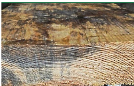
Blåsplint - angrebet nåltræ i marvstråler fra overfladen til træets kerne. (Foto: PROTOX)
