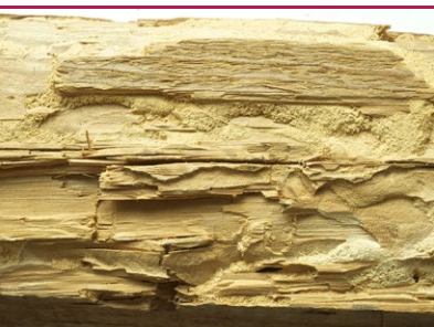
i 2 Husbuk - frilagte larvegange med boremel. (Foto: PROTOX/EFI Global arkiv)
