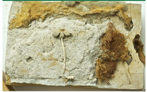
Husblækhat - frugtlegerer (hat og stok) og orangebrunt, sejt, kokosmåtte-agtigt overflademycelium. (Foto: PROTOX/EFI Global arkiv)
