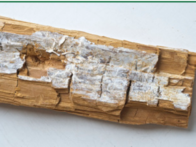
sv 13 Hvid Tømmersvamp - nedbrudt træ (brunmuld) og overflademycelium. (Foto: Protox/Goritas arkiv)
