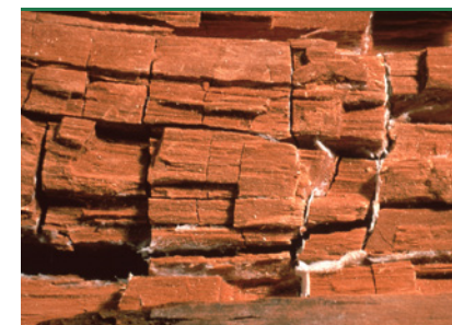
Brunmuld - svampen nedbryder cellulosefibrene og efterlader ligninen.
