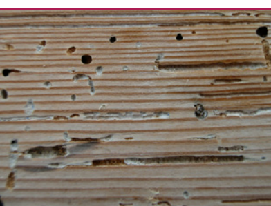
i 11 Alm Borebille - gulvbræt med frilagte larvegang som følge af afhøvling. (Foto: Protox)
