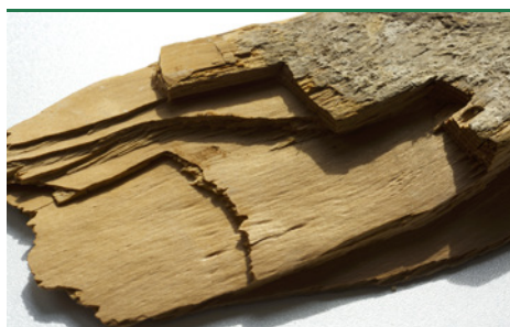
svn 42 Gul Tømmersvamp - brunmuld, bladet nedbrydning. Vurderes som svampeskade. (Foto: Protox/Goritas arkiv)
