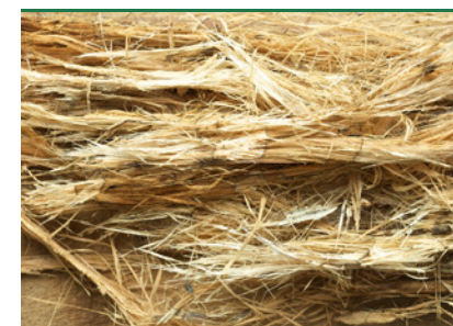
Hvidmuld - svampen nedbryder ligninen i træet og efterlader cellulosetrådene. Derved trævler træet.
