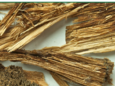
sv 26 Sammenhængende ildporesvamp - nedbrudt træ (hvidmuld) med brunlig belægning. (Foto: Protox/Goritas arkiv)
