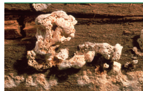
Rækkeporesvamp - sterile, blomkålsagtige frugtlegemer fremvokset i mørke. (Foto: Protox/Gori)
