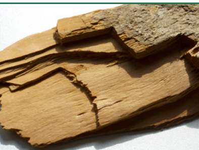
Gul Tømmersvamp - bladet nedbrydning (svampeskade). (Foto: Protox/Goritas arkiv)
