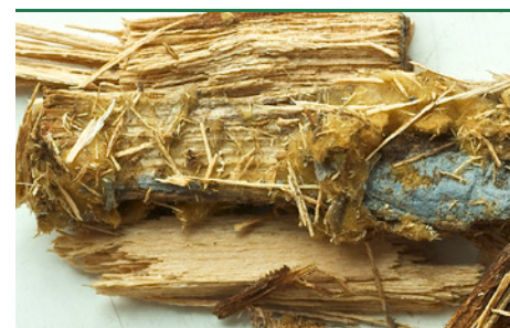
Sammenhængende Ildporesvamp - overflademycelium som karrygule totter (blågrønt parti er skimmelsvampe). (Foto: Protox/Goritas arkiv)
