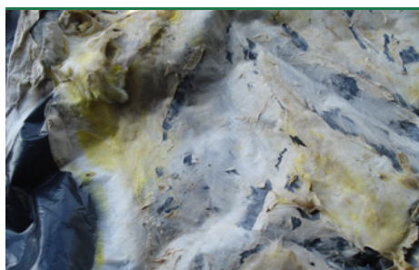
svn 30 Ægte Hussvamp - overflademycelium med karakteristiske gule pletter. (foto: Protox)
