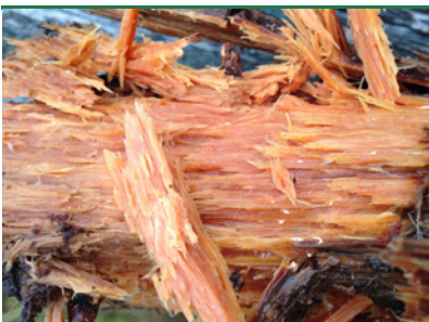
Mastesvamp - Nedbrudt træ. (Foto: Protox) sv 28
