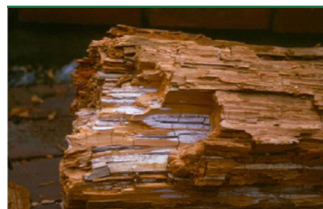
Hvid Tømmersvamp - nedbrydning og hvidt overflademycelium på brudflader. (Foto: Goritas)
