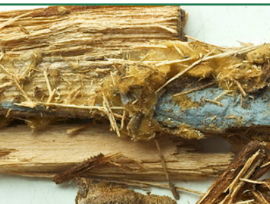
sv 25 Sammenhængende ildporesvamp - nedbrudt træ (hvidmuld) og totter af karrygult overflademycelium. (Foto: Protox/Goritas arkiv)
