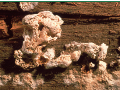
sv 15 Rækkeporesvamp - sterile frugtlegerer udviklet i mørke. (Foto: Protox/Gori)
