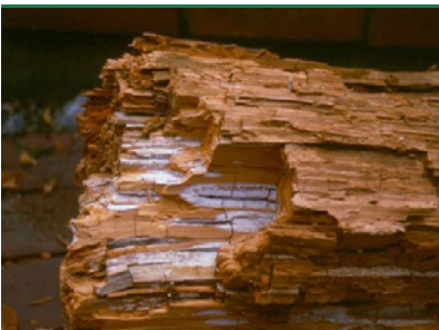
Hvid Tømmersvamp - sprækkeklodser. (Foto: Goritas A/S)
