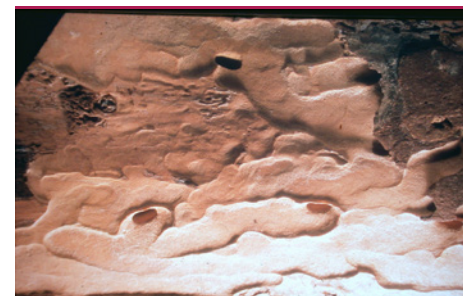
Violbuk - gnavspor i nåletræ mellem bark og træets yderste årringe. (Foto: Hussvamp Laboratoriet)
