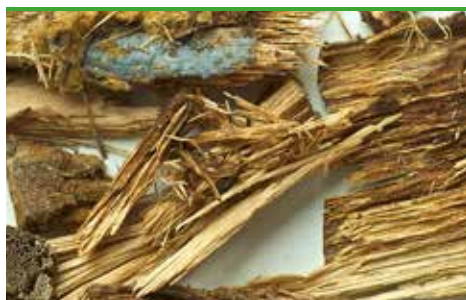
svn 51 Eldticka - trådig nedbrytning och blå-grön påväxt är mögelangrepp (foto - Protox/Goritas arkiv)
