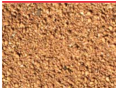
Skäckig trägnagare - linsformade exkrementer borrmjöl (foto - Protox/Goritas arkiv)
