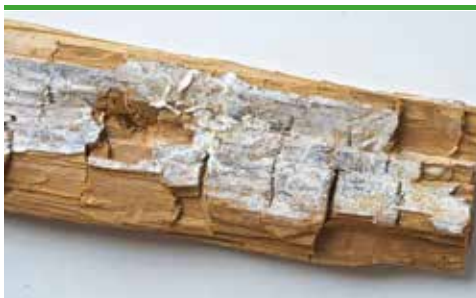
svn 34 Mögelticka- vitt ytmycel på angripet virke med sprickklossar (foto - Protox/Goritas arkiv)
