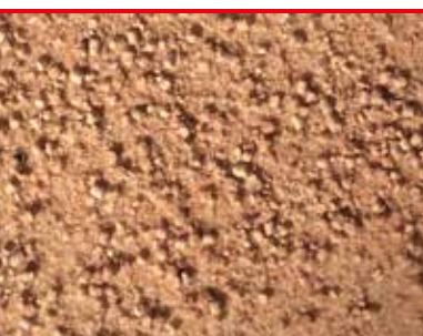
i 3 Husbock - bormjöl med karakteris- tiska vinkork-formade exkrementer (foto - Protox/Goritas arkiv)
