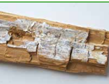
SV 13 Timmerticka- nedbrutet virke (brunröta) och ytmysel (foto - Protox/Goritas arkiv)
