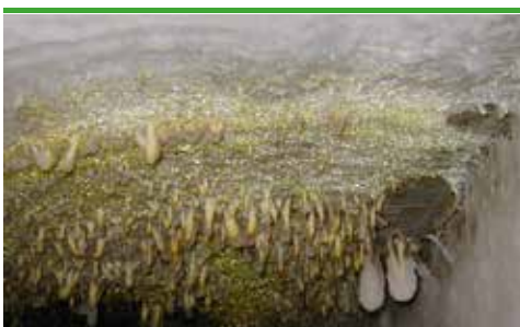
svn 28 Åkta Hussvamp- ytmycel med vattendroppar (foto - Bøgh & Helstrup)
