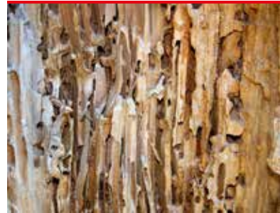
Hushästmyra - Galleri av gångar bildat genom att endast den hårda höstveden kvarstår (foto okänd)
