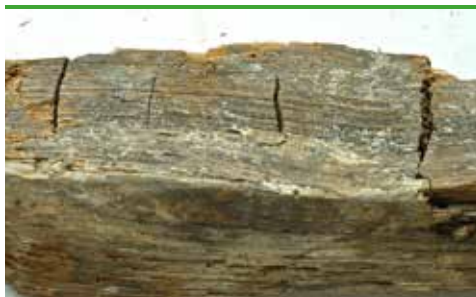
svn 44 Äkta Hussvamp- gammalt angrepp. Svaga ytmycelrester och tydliga tvärgående sprickor (foto - Protox)
