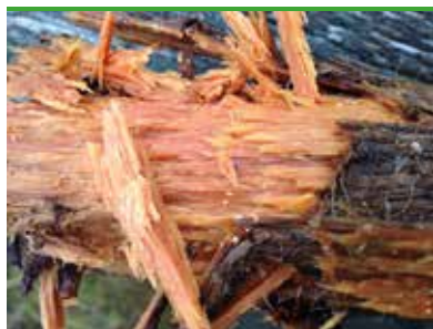
Opalporing – nedbrutet virke (foto - Protox)
