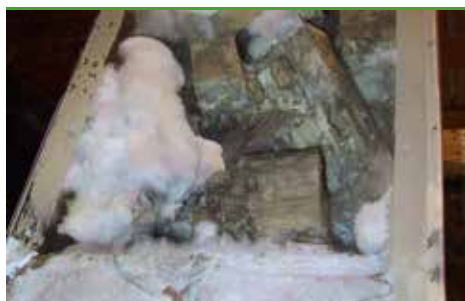
svn 29 Åkta Hussvamp- ungt ytmycel, 2 veckor (foto - Protox)
