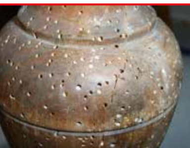
i 10 Stripet borebille - flyvehull i bord- ben (foto - Protox)
