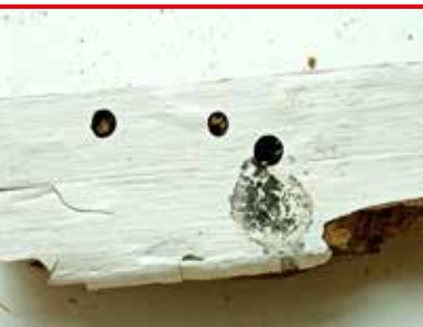
i 15 Rød Blomsterbukk - flyvehull 5-8 mm skarpt kantede og runde. (foto - Protox/Goritas arkiv)
