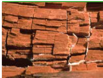
Brunråte - soppen bryter ned cellulosefibre og etterlater ligninet
