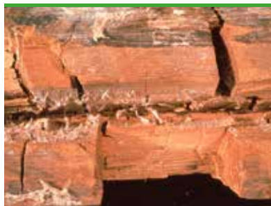
Ekte hussopp - sprekkeklosser (foto - Protox/Gori A/S)
