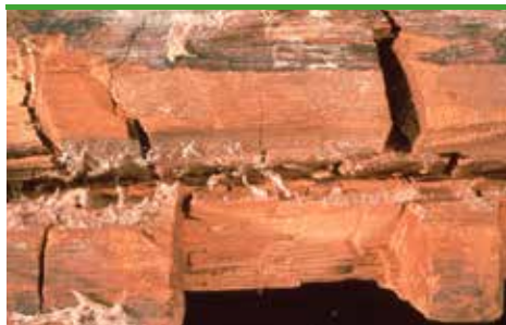
svn 49 Ekte hussopp - nedbrutt trebjelke, Brunmuld med store sprekkeklosser og overflatemycel (foto - Protox/Gori)
