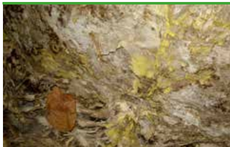
svn 25 Ekte hussopp - overflatemycel med karakteristiske gule flekker (foto - Protox)
