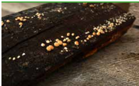
svn 16 Rottåre - fruktlegermer på takfotbord (foto - Protox)
