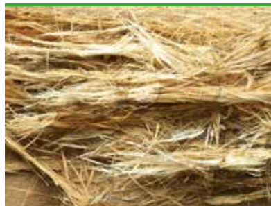
Hvitråte - soppen bryter ned ligninet i treet og etterlater cellulosestrådene. Dermed treflett treet seg
