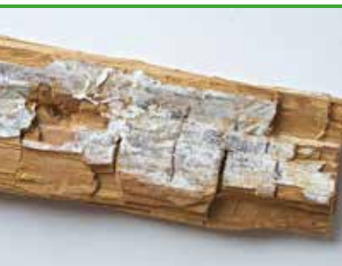
sv 13 Hvit tømmerkjuke - nedbrutt tre (brunmuld) og overflatemycel (foto - Protox/Goritas arkiv)
