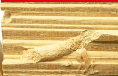
inn 30 Treveps - larvegang med hardt pakket boremel. (foto - Protox/Goritas arkiv)
