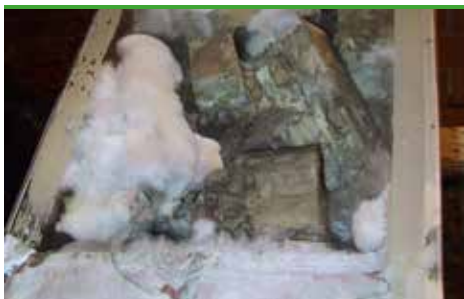
svn 29 Ekte hussopp - ungt overflatemycel, 2 uker (foto - Protox)
