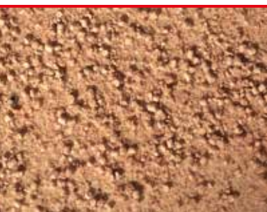
i 3 Husbukk - boremel med karakteris- tiske vinkork-formede ekskrementer (foto - Protox/Goritas arkiv)
