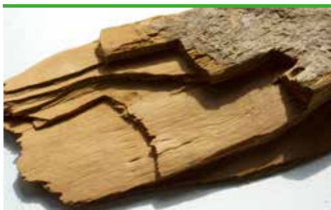
svn 42 Kjellersopp - brunrâte, bladet nedbryting. Vurderes som soppskade (foto - Protox/Goritas arkiv)
