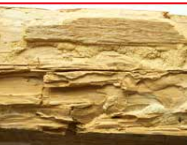
i 2 Husbukk - frilagte larveganger med boremel (foto - Protox/Goritas arkiv)
