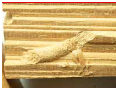
Trepeps - larvegang med hardt pakket boremel. (foto - Protox/Goritas arkiv)
