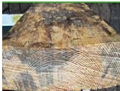
Blåråte - legg merke til den dyp- gående misfargingen på tvers av årringene (foto - Protox)
