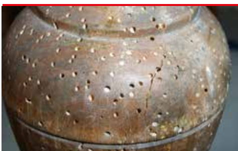
inn 17 Stripet Borebille - flyvehull i bordben (foto - Protox)
