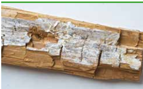
svn 34 Hvit tømmerkjuke - hvitt overflatemycel på nedbrutt tre med sprekkeklosser (foto - Protox/Goritas arkiv)
