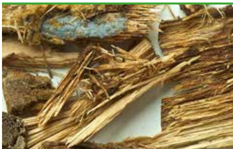
svn 51 Sammenhengende ildkjuke - trevlet nedbryting og blågrønt belegg er muggangrep (foto - Protox/Goritas arkiv)
