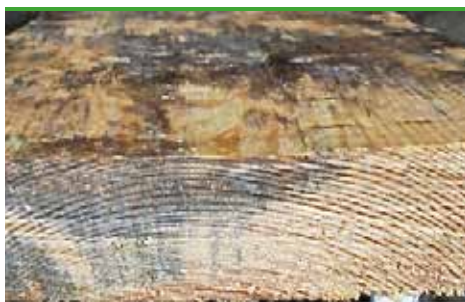
svn 59 Blåråte - angrepet bartrær i margstråler fra overflaten til treets kjerne (foto - Protox)
