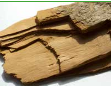
sv 8 Kjellersopp - bladet nedbryting (soppskade) (foto - Protox/Goritas arkiv)
