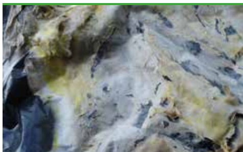
svn 30 Ekte hussopp - overflatemycel med karakteristiske gule flekker (foto - Protox)
