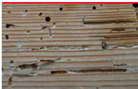
inn 16 Stripet Borebille i gulvbord - flyvehull og larveganger frilagt på grunn av avhøvling (foto - Protox)
