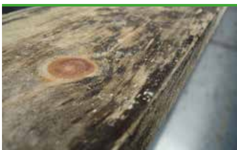
svn 60 Blåråte og sortmugg på bartrær (foto - Protox)
