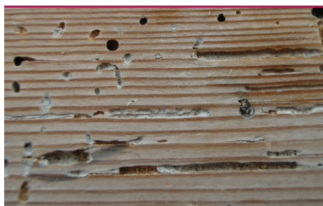
in 16 Gemeiner Nagekäfer in Holzziele - Schlupflöcher und Larvengänge, durch Hobeln freigelegt. (Foto: Protox)
