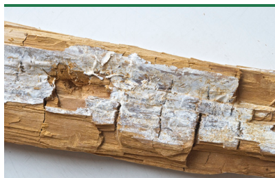
Weißer Porenschwamm- zersetztes Holz (Braunfäule) und Oberflächenmyzel. (Foto: Prottox/Goritas Archiv)
