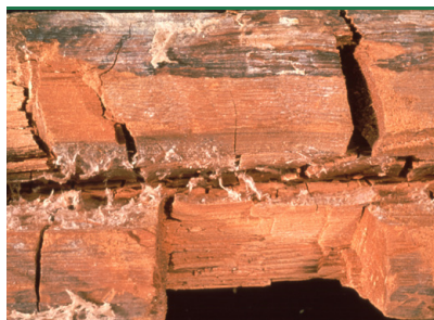
Echter Hausschwamm - Würfelbruch. (Foto: Protox/Gori A/S)
