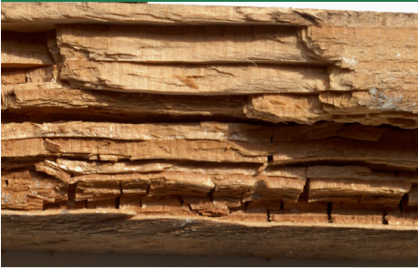
Reihige Braunfäuletramete (Weißer Porenschwamm) - Zersetzung. (Foto: Protox)
