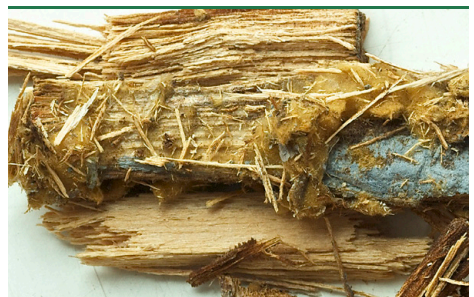
Großsporiger Feuerschwamm – Oberflächenmyzel als currygelbe Büschel (der blau-grüne Teil sind Schimmelpilze). (Foto: Protox/Goritas Archiv)
