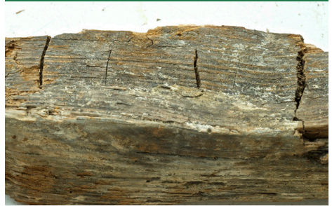
Echter Hausschwamm - alter Befall. Schwache Myzelreste und deutlich querverlaufende Risse. (Foto: Protox/Goritas Archiv)
