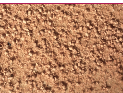
i 3 Hausbock - Bohrmehl mit charakteristischen korkenförmigen Exkrementen. (Foto: Protox/Goritas Archiv)
