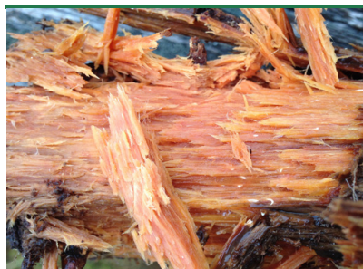
Wässeriger Porling - zersetztes Holz. (Foto: Protox)
