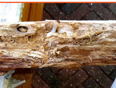
Zersetztes Holz mit Insektenbefall
