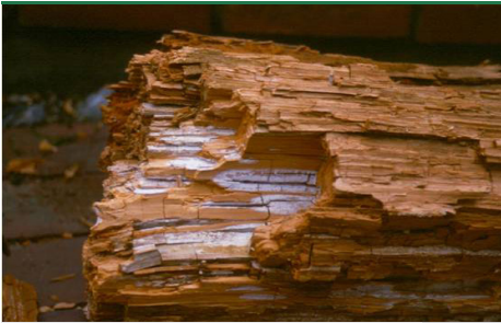
Weißer Porenschwamm - Zersetzung und weißes Oberflächenmyzel auf Bruchflächen. (Foto: Goritas)
