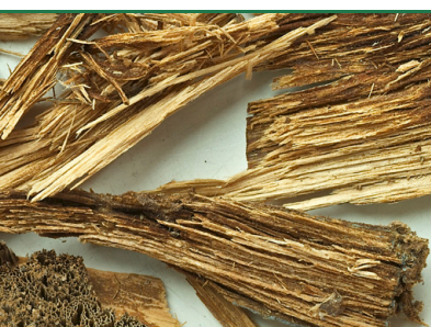
Grobssporiger Feuerschwamm - zer- setztes Holz (Weißfäule) mit bräun- lichem Belag. (Foto: Protox/Goritas Archiv)
