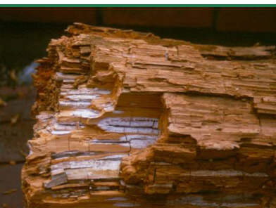
Weißer Porenschwamm - Würfelbruch. (Foto: Goritas A/S)
