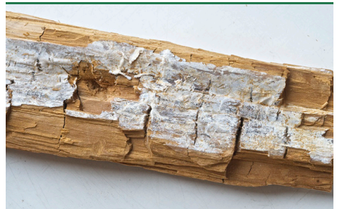
Weißer Porenschwamm – weißes Oberflächenmyzel auf zersetztem Holz mit Würfelbruch. (Foto: Protox/Goritas Archiv)
