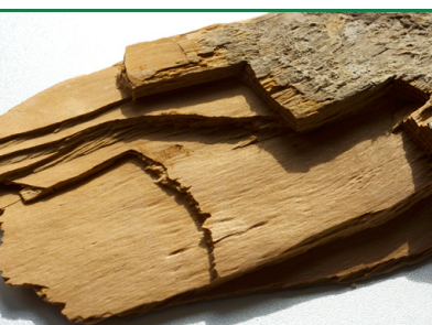
Brauner Kellerschwamm – Zersetzung mit Abblättern (Pilzschaden) (Foto: Protox/Goritas Archiv)
