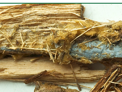
Grobssporiger Feuerschwamm - zer- setztes Holz (Weißfäule) und Büschel von currygelbem Oberflächenmyzel. (Foto: Protox/Goritas Archiv)
