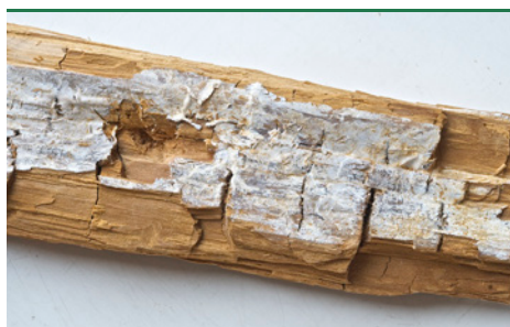
Hvid Tømmersvamp - hvidt overflademycelium på nedbrudt træ med sprækkeklodser. (Foto: Protox/Goritas arkiv)
