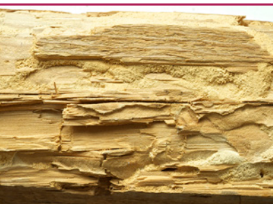
i 2 Husbuk - frilagte larvegange med boremel. (Foto: Protox/Goritas arkiv)
