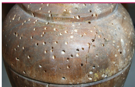
in 17 Alm. Borebille - flyvehuller i bordben. (Foto: Protox)
