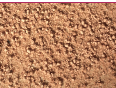
i 3 Husbuk - boremel med karakteristiske vinprop-formede ekskrementer. (Foto: Protox/Goritas arkiv)
