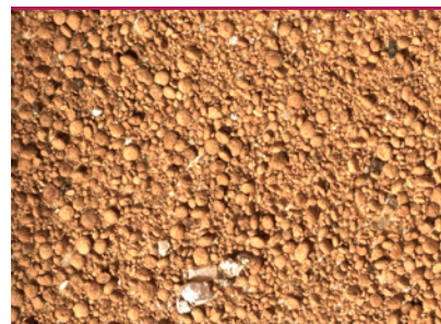
Egens Borebille - linseformede ekskrementer i boremel. (Foto: Protox/Goritas arkiv)
