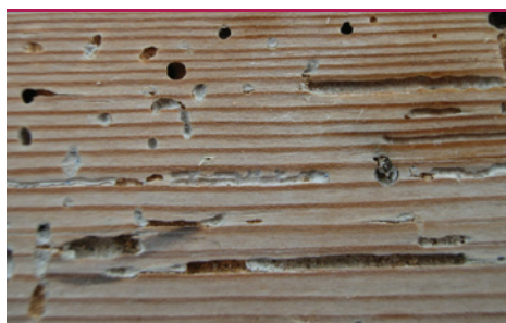
in 16 Alm. Borebille i gulvbræt - flyvehuller og larvegange frilagte på grund af afhøvling. (Foto: Protox)
