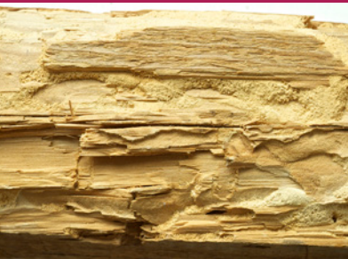
i 2 Hausbock - freigelegte Larvengänge mit Bohrmehl. (Foto: Protox/Goritas Archiv)
