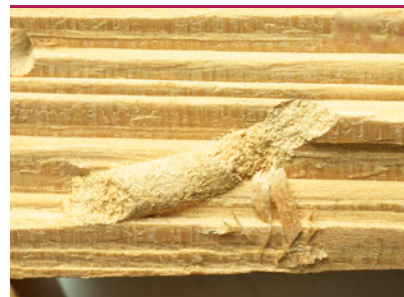
Holzwespe - Larvengang mit hartem, gepresstem Bohrmehl. (Foto: Protox/Goritas Archiv)
