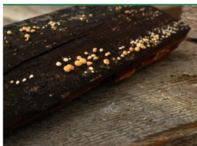
Bewurzelter Schüsselpilz – Fruchtkörper auf Holzwerk im Außenbereich. (Foto: Prottox)
