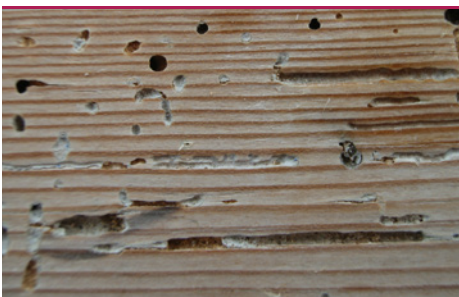
in 16 Gemeiner Nagekäfer in Holzdielen - Schlupflöcher und Larvengänge, durch Hobeln freigelegt. (Foto: Protox)
