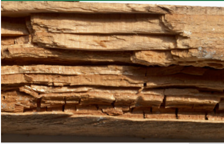
Reihige Braunfäuletramete (Weißer Porenschwamm) - Zersetzung. (Foto: Protox)
