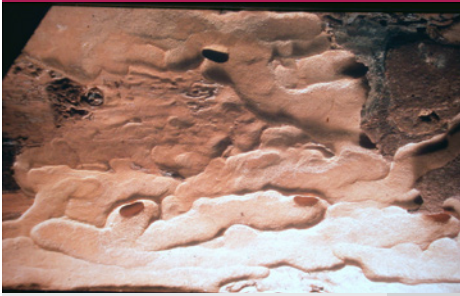
Blauvioletter Scheibenbock - Nagespur in Nadelholz zwischen Rinde und äußersten Jahresringen. (Foto: Hussvamp Laboratoriet)
