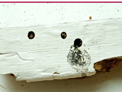
i 15 Rothalsbock- Schlupflöcher 5-8 mm, scharfkantig und rund. (Foto: Protox/Goritas Archiv)
