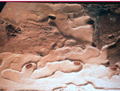
i 7 Blauvioletter Scheibenbock - Nagespuren in den äußersten Jahresringen. (Foto: Hussvamp Laboratoriet)
