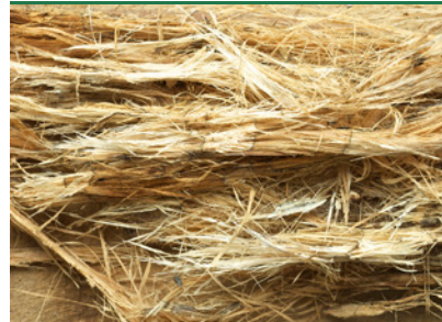
Weißfäule – der Pilz zersetzt das Lignin im Holz und hinterlässt Zellulosefäden. Dadurch zerfasert das Holz.
