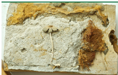
Haustintling - Fruchtkörper (Hut und Stiel) und orange-braunes, zähes, kokosmattenartiges Oberflächenmyzel. (Foto: Protox/Goritas Archiv)
