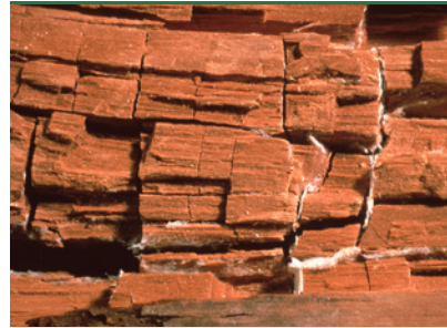
Braunfäule – die Zellulosefasern werden vom Pilz zersetzt, es bleibt Lignin übrig.
