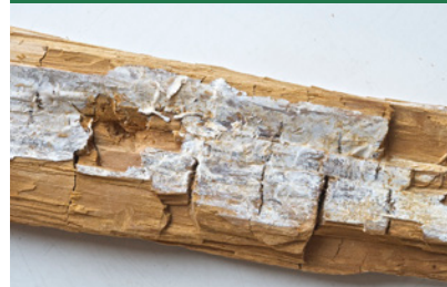
Weißer Porenschwamm- zersetztes Holz (Braunfäule) und Oberflächenmyzel. (Foto: Protox/Goritas Archiv)
