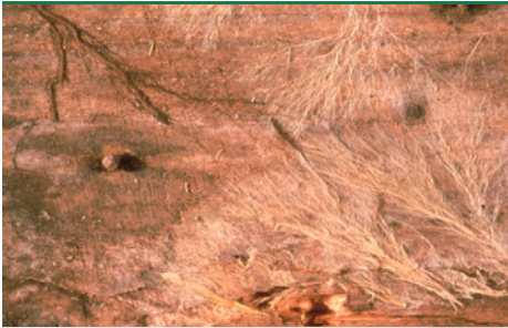
Brauner Kellerschwamm - charakteristisches dunkles und helles Strangmyzel. (Foto: Protox/Gori)
