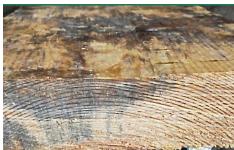
Bläue - Befall eines Nadelgehölzes, von den Markstrahlen bis zum Holzkern. (Foto: Prottox)
