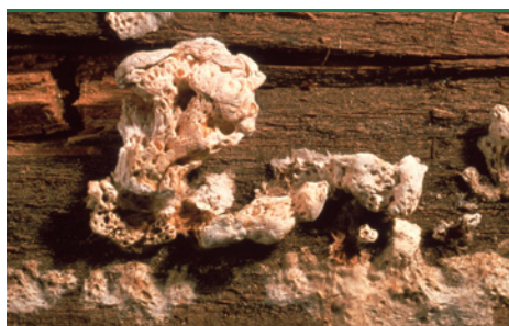
Reihige Braunfäuletramete - sterile, blumenkohlartige Fruchtkörper, im Dunkeln gewachsen. (Foto: Protox/Gori)
