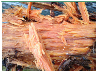
Wässeriger Porling - zersetztes Holz. (Foto: Protox)
