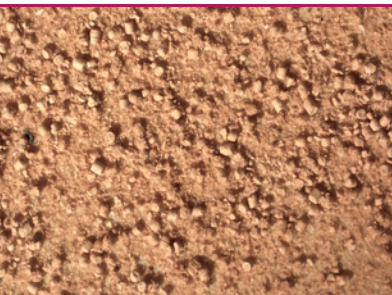
i 3 Hausbock - Bohrmehl mit charakteristischen korkenförmigen Exkrementen. (Foto: Protox/Goritas Archiv)
